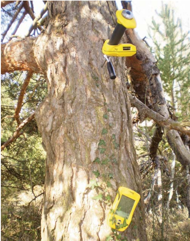
Aparato Hit-man ST300 de medición del módulo de elasticidad en árboles en pie.
